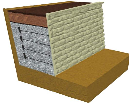
Terra Panel adalah susunan beton bertulang yang disusun secara vertikal dan berintegrasi satu dan lainnya yang dikombinasikan dengan geogrid atau belt, serta lapisan material timbunan yang dipadatkan.
