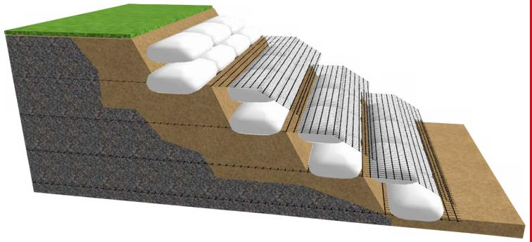
Terra Wrapped Around adalah perkuatan lereng dengan menggunakan soil/sand bag yang disusun secara terintegrasi dan dilipat secara berlapis dengan menggunakan geogrid PET/HDPE.
