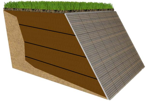
Terra Frame adalah perkuatan lereng dengan menggunakan wiremesh sebagai facing (muka) yang dilapisi dengan geotextile non woven dan dikombinasikan dengan geogrid PET/HDPE serta lapisan material timbunan yang dipadatkan.
