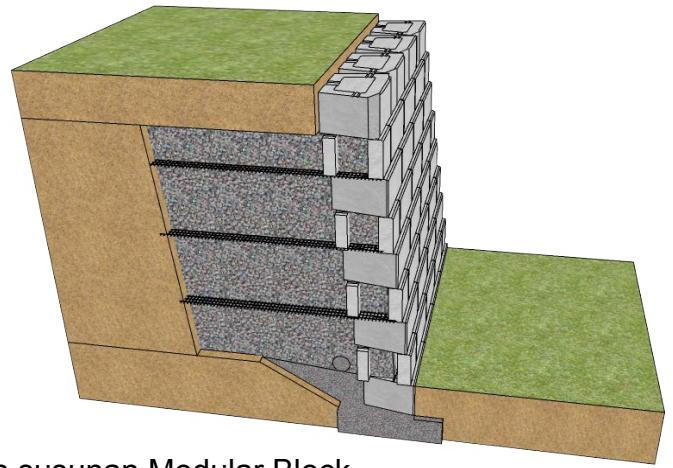
Omega Wall adalah dinding vertikal yang merupakan susunan Modular Block disusun secara terintegrasi (interlocking) satu dengan lainnya dan dikombinasikan dengan Geogrid dan lapisan material yang dipadatkan.
