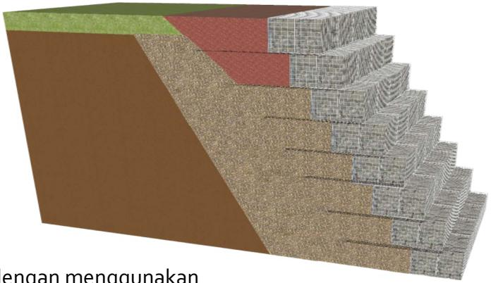
Terra Gabion adalah perkuatan lereng atau timbunan dengan menggunakan bronjong PP atau kawat galvanis yang disusun secara terintegrasi dan dikombinasikan dengan Geogrid PET/HDPE.
